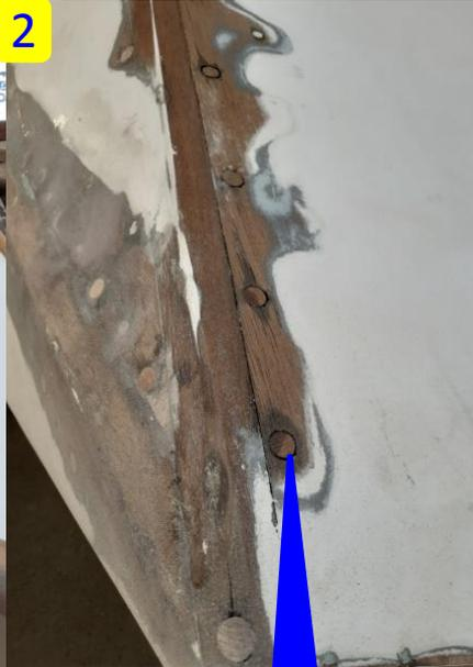
Tapons ajustés pour fixation des bords en partie inférieure
