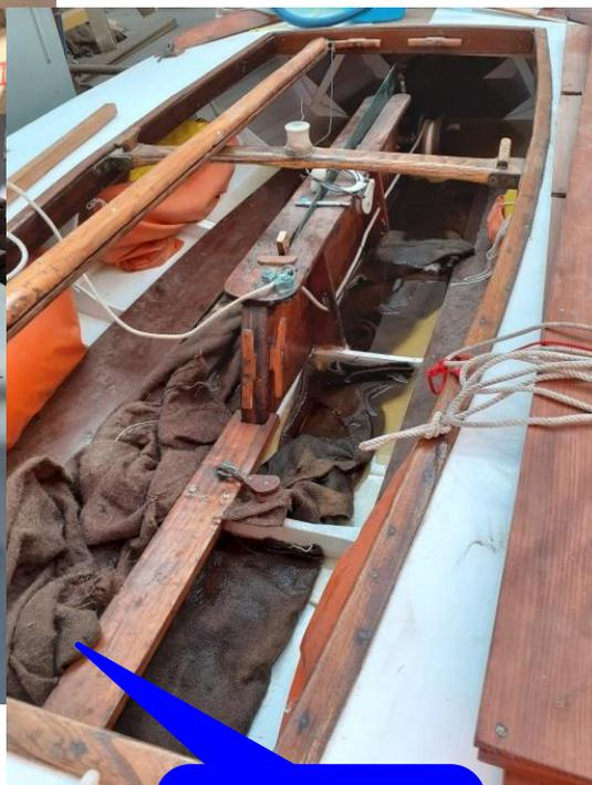
Le caneton Aubin en phase de gonflage avec les sacs de jute imbibés d'eau....apparemment il ne fuit plus!
