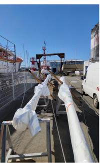
Les mâts sont déposés et alignés sur les tréteaux et protégés par des bâches. Ils devront subir quelques réparations, des gerces étant apparues. Les fourrages de haubans ont été révisés.
