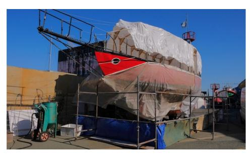
primaire époxy qui est déposée jusqu'à la ligne de flottaison.
