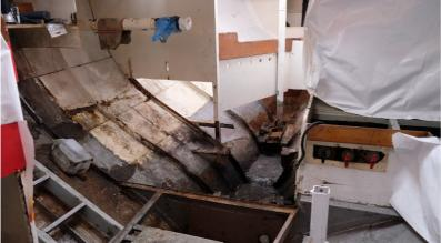
Une fois le démontage effectué, il devient évident qu'un sablage intérieur était devenu nécessaire, comme la réfection du câblage électrique.
