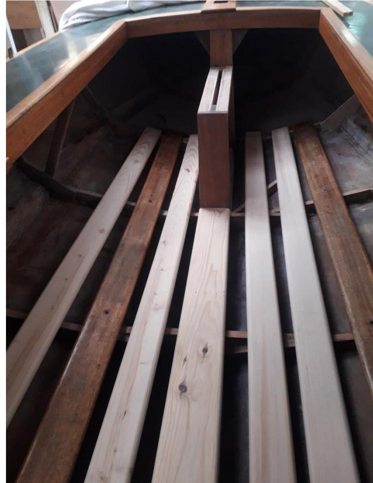
Après dégauchissage et rabotage positionnement des lattes
