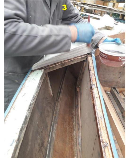
**Le Chantier Flibustier;** remplacement des plat-bord défectueux
