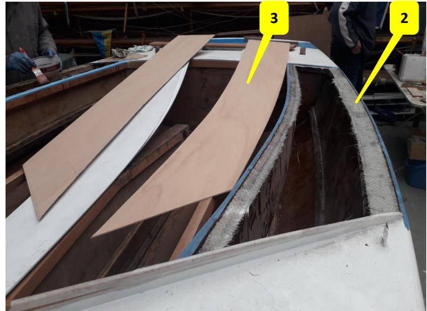
**Le Chantier Flibustier;** remplacement des plat-bord défectueux
