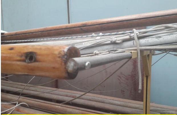
Broche de tête de mat reprise sur râtelier à mats avec vis à bois et rondelle.
