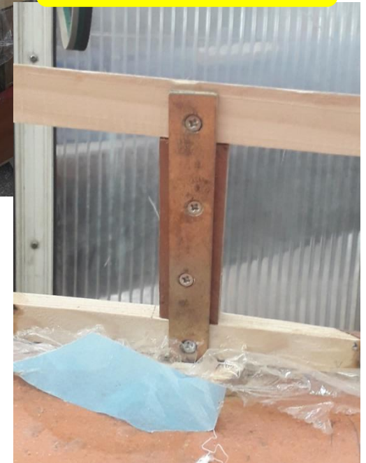
Détails de fixation des cadènes sur les membrures
