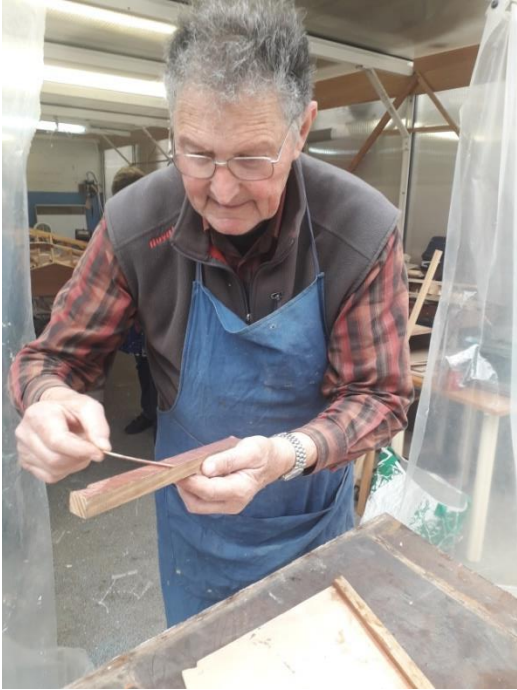
Christian assemble et colle les différentes pièces du puit de dérive
